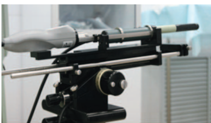
Рис. 3. Трансректальный ультразвуковой датчик, закрепленный на специальном фиксирующем устройстве «степпере»
